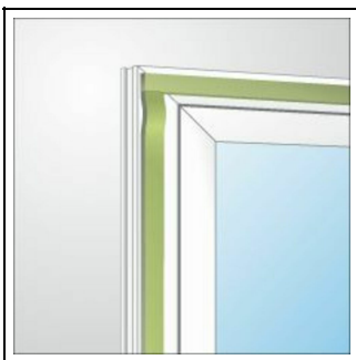
1. Bild: Bandverlegung bei der Fenstermontage
